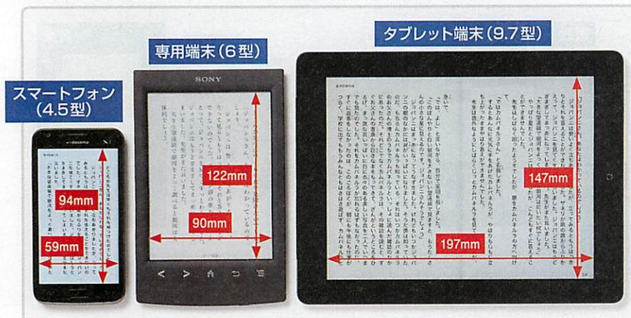
図1 スマートフォン(NTTドコモのGALAXY S II LTE SC-03D)、専用端末(ソニーのReader PRS-T2)、タブレット端末(アップルのiPad)で小説を表示したところ。専用端末は文庫本の1ページを少し小さくした程度。タブレット端末は横置きにすると見開きで読める
