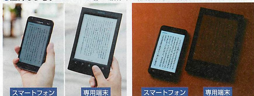
図2 液晶ディスプレイを搭載したスマートフォンは屋外の明るい場所では読みづらい。外光を反射する電子ペーパーを備えた専用端末の方が格段に読みやすい。暗い場所ではバックライトが付いている液晶ディスプレイが視認性に優れる
